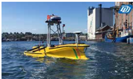
Danmarks første sejlede autonome drone til søopmålinger på prøvesejlads i Svendborg Havn
